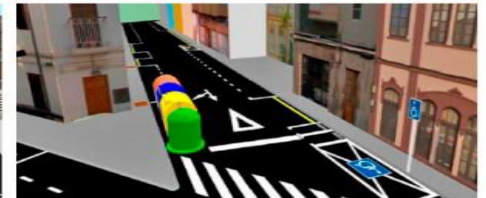
AMPLIACIÓN ACERA DE LA ESQUINA EN FORMA TRIANGULAR PARA PROTECCIÓN DE PEATONES, ENTRE CALLE HORACIO NELSON Y LOS SUEÑOS, DESPLAZÁNDOSE EL PASO DE PEATONES HASTA EL FINAL DE DICHA ESQUINA. SE MEJORA LA SEGURIDAD PEATONAL Y LA VISIBILIDAD DEL CRUCE DE TRÁFICO.
