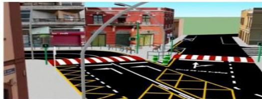
AMPLIACIÓN ACERA DE LA ESQUINA EN FORMA TRIANGULAR PARA PROTECCIÓN DE PEATONES, ENTRE CALLE HORACIO NELSON Y LOS SUEÑOS, DESPLAZÁNDOSE EL PASO DE PEATONES HASTA EL FINAL DE DICHA ESQUINA. SE MEJORA LA SEGURIDAD PEATONAL Y LA VISIBILIDAD DEL CRUCE DE TRÁFICO.
