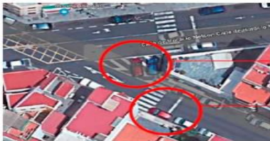
AMPLIACIÓN ACERA DE LA ESQUINA EN FORMA TRIANGULAR PARA PROTECCIÓN DE PEATONES, ENTRE CALLE HORACIO NELSON Y LOS SUEÑOS, DESPLAZÁNDOSE EL PASO DE PEATONES HASTA EL FINAL DE DICHA ESQUINA. SE MEJORA LA SEGURIDAD PEATONAL Y LA VISIBILIDAD DEL CRUCE DE TRÁFICO.
